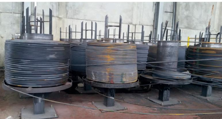
Auf 3-t-Spulen gewickelte Längsdrähte mit Durchmesser 18 mm
