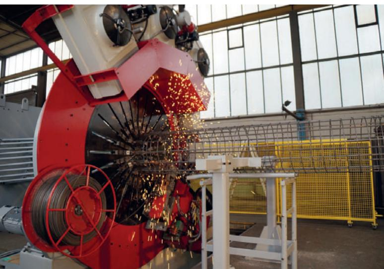
Automatische Korbschweißmaschine USM zur Herstellung von Bewehrungskörben für Bohrpfähle
