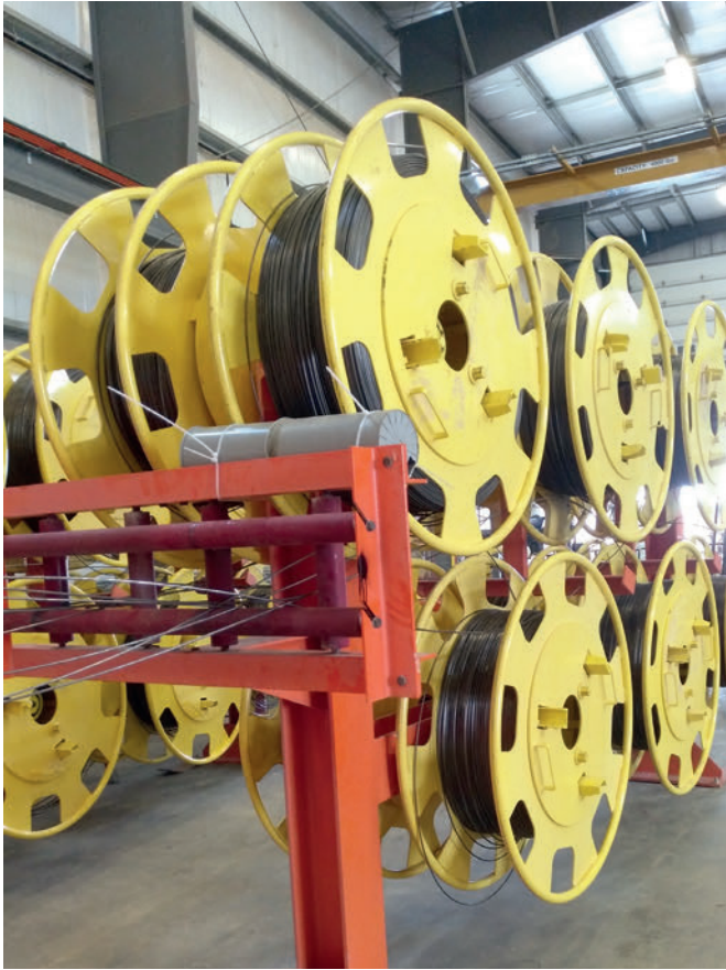
Die Coils werden auf Ständern kompakt angeordnet.
