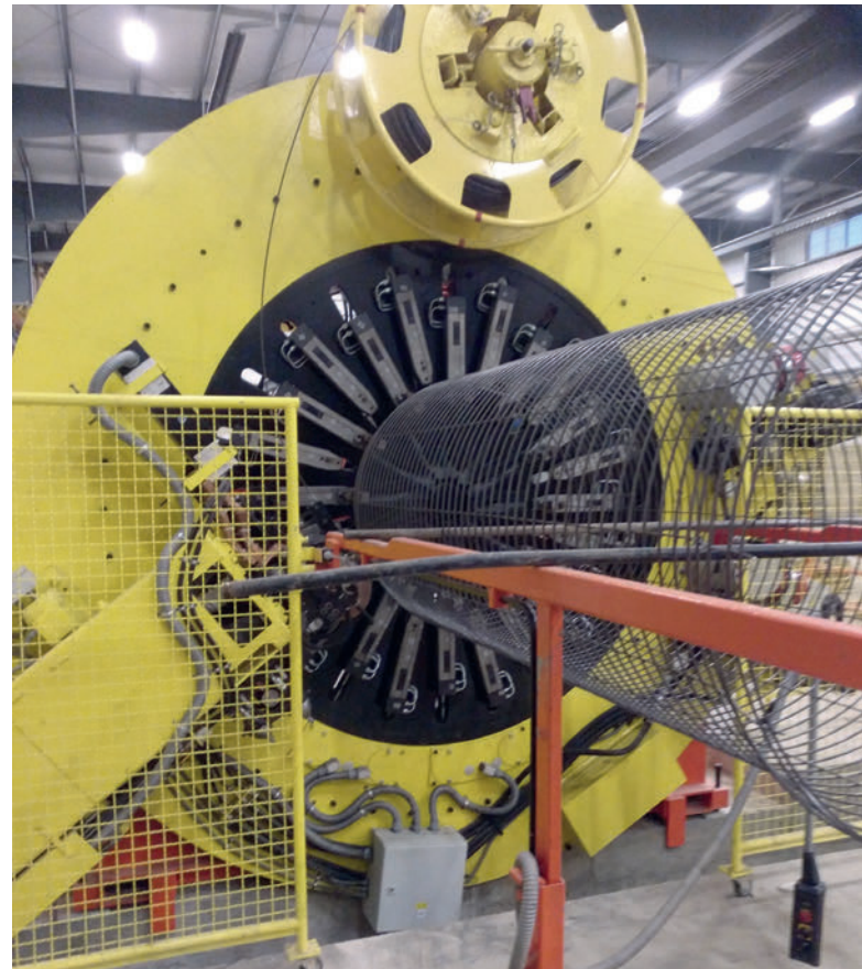
Ein rotierender Schweißkopf samt Haspel sorgt dafür, dass ein Korb nach dem anderen gefertigt werden kann.
