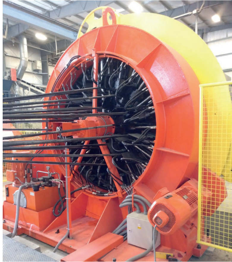
Die Längsdrähte werden von Coils abgerollt und vollautomatisch in die Maschine eingeführt.
