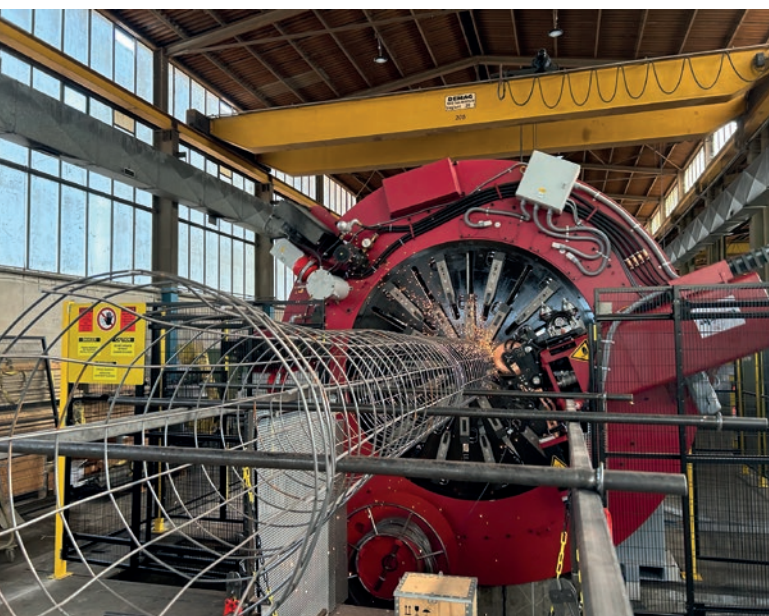
Vollautomatische Bewehrungskorbschweißmaschine der ASMS-Baureihe
